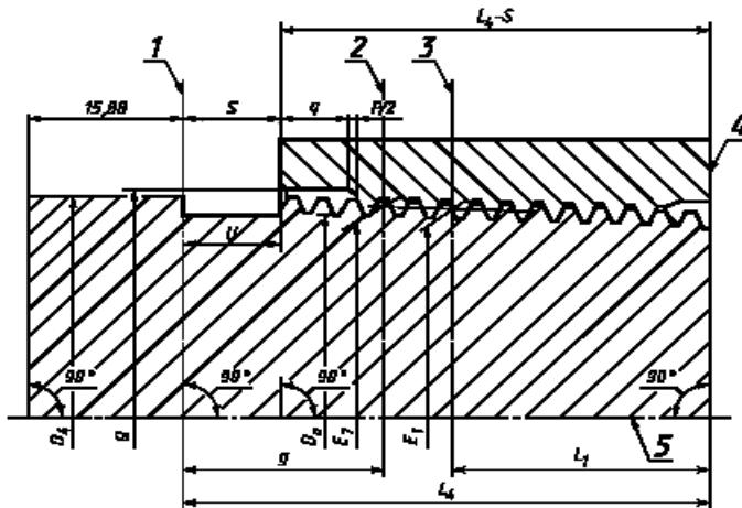
1 — плоскость конца сбега резьбы; 2 — основная плоскость; 3 — плоскость сопряжения от рукоятки; 4 — плоскость торца трубы; 5 — ось резьбы
