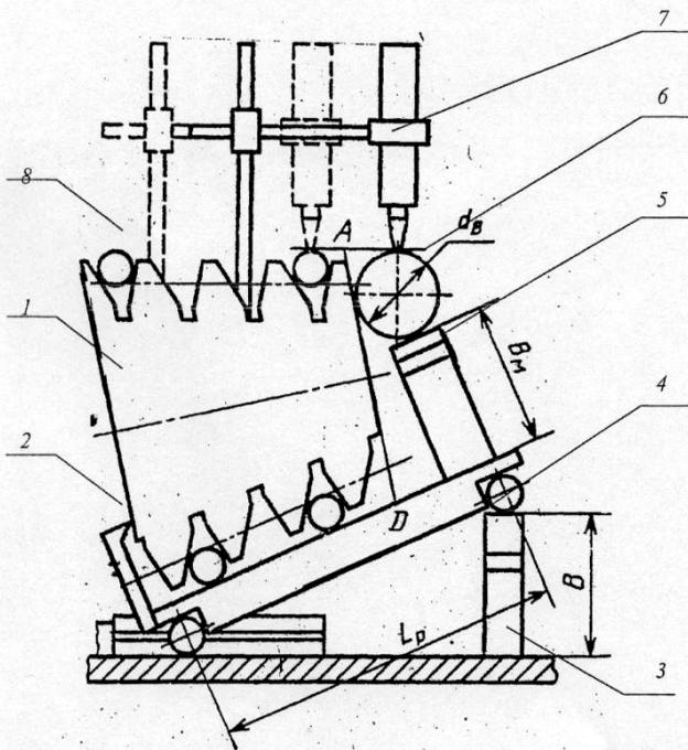
Проверяемый калибр устанавливают на синусную линейку, снабженную упорной планкой так, чтобы торец фланца касался упора (Рисунок 4).
