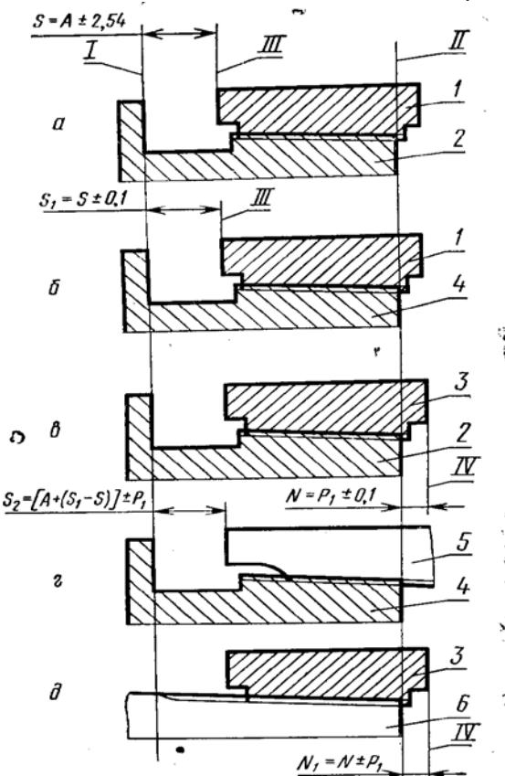
I—измерительная плоскость калибров-пробок (рабочего и контрольного), соответствующая концу сбега резьбы трубы; II—измерительная плоскость контрольного калибра-пробки, соответствующая торцу трубы; III—измерительная плоскость контрольного калибра-кольца; IV—измерительная плоскость рабочего калибра-кольца; 1—контрольный калибр-кольцо; 2—контрольный калибр-пробка; 3—рабочий калибр-кольцо; 4—рабочий калибр-пробка; 5—муфта; 6—труба.
